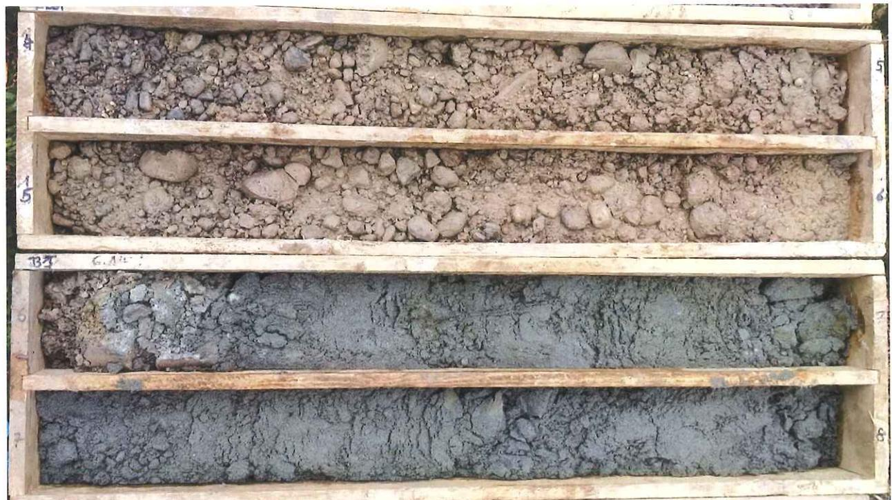
Bohrkern B 1 8,0 - 10,0 m:
