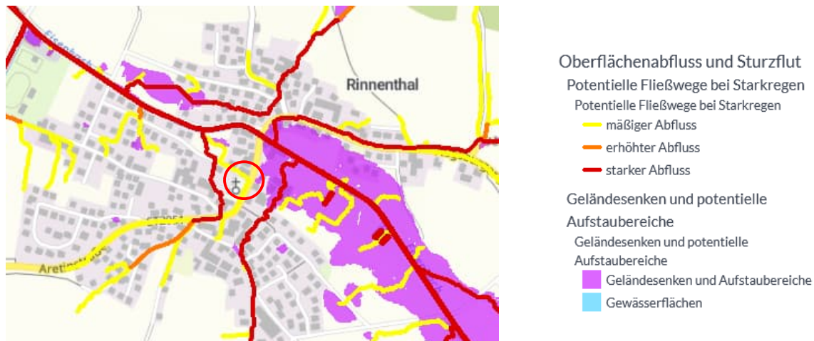
Abb. 2: Darstellung des Oberflächenabflusses mit potenziellen Fließwegen bei Starkregen sowie Geländesenken und potenziellen Aufstaubereichen im Planungsgebiet (LfU 2025)
