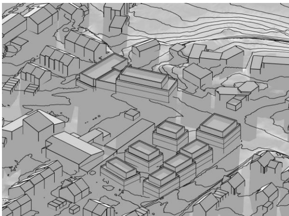
Abbildung 23: Vershattungsanalyse zum Bebauungsplanentwurf mit Blick nach Südwesten für den Tag 21.12. um 9 Uhr (oben links), 12 Uhr oben rechts und 15.30 Uhr unten links, o. M.
