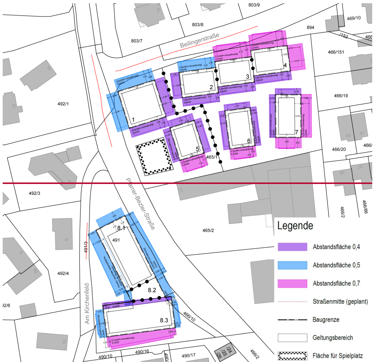
Abbildung 24: Abstandsflächenplan, i. d. Fassung vom 29.05.2026, o. M.
