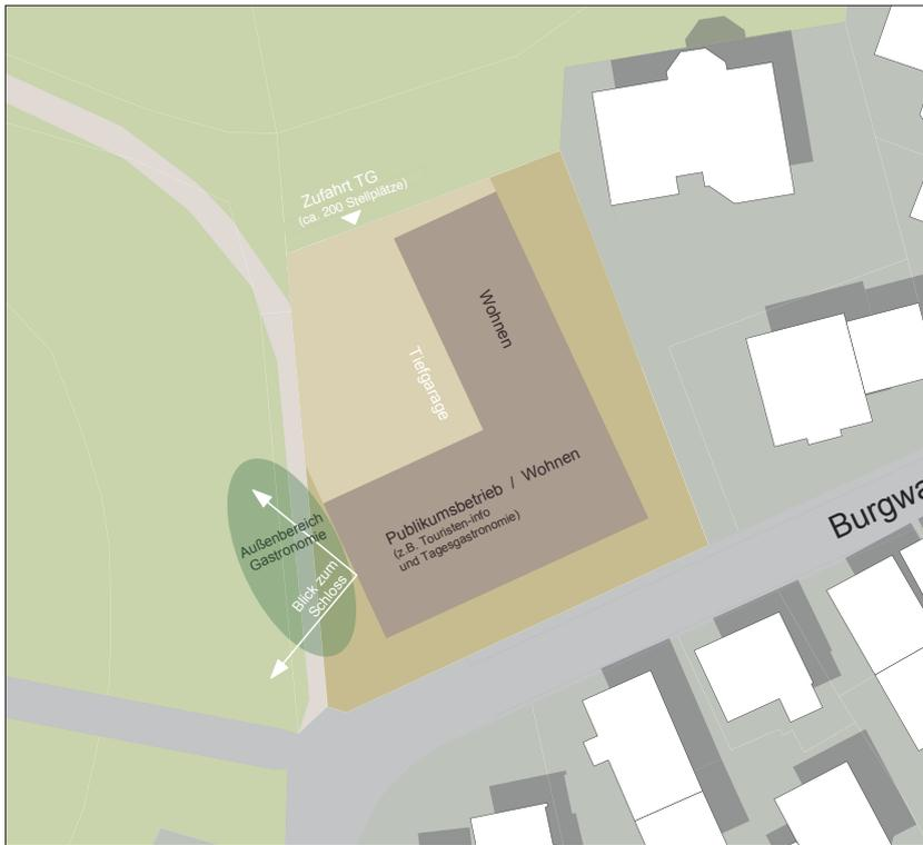
Abb. 63: Entwicklungsvorschlag Burgwallstraße 5 - mind. zwei Untergeschosse mit Tiefgarage (ca. 200 Stellplätze), EG mit möglicher Mischnutzung (ohne Maßstab)
