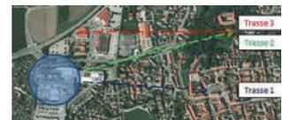
Abb. 101: Trassenvarianten des Semesterprojektes "Seilbahn für Friedberg" an der Hochschule Augsburg 2013
