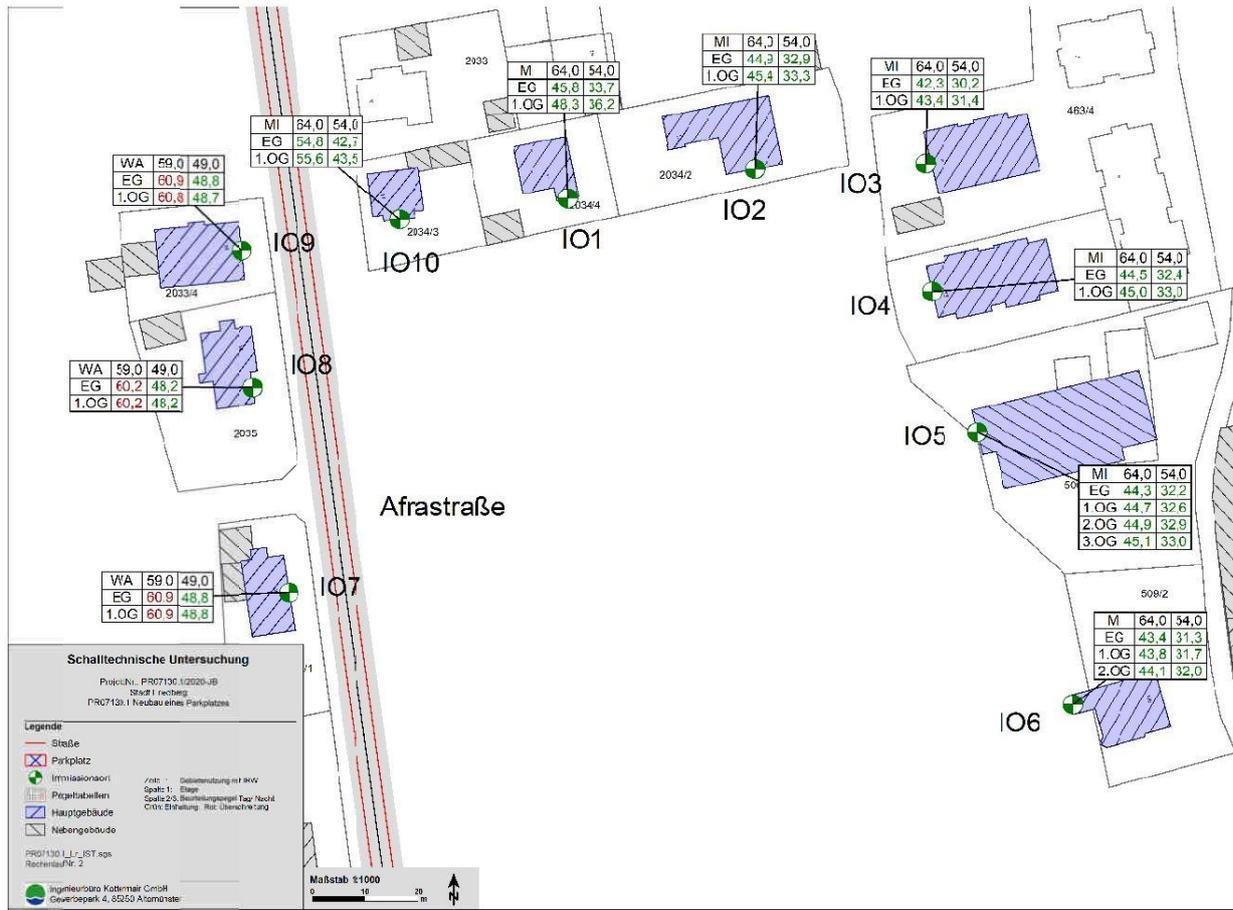
Abb. 5: Verkehrslärm Afrastraße (Ist-Situation) - Anlage der Schalltechnischen Untersuchung (IB Kottermair 2020)
