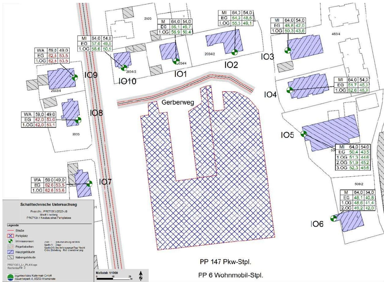
Abb. 6: Verkehrslärm Afrastraße / Parkplatz (Plan-Situation) - Anlage der Schalltechnischen Untersuchung (IB Kottermair 2020)
