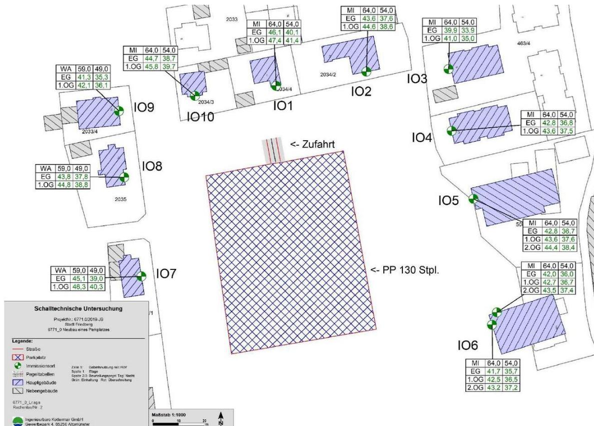
Abb. 3: Verkehrslärm Parkplatz - Anlage der Schalltechnischen Untersuchung (IB Kottermair 2019)
