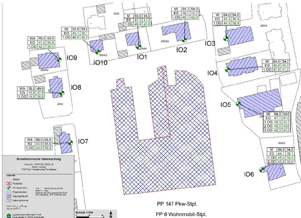
Abb. 4: Verkehrslärm Parkplatz - Anlage der Schalltechnischen Untersuchung (IB Kottermair 2020)
