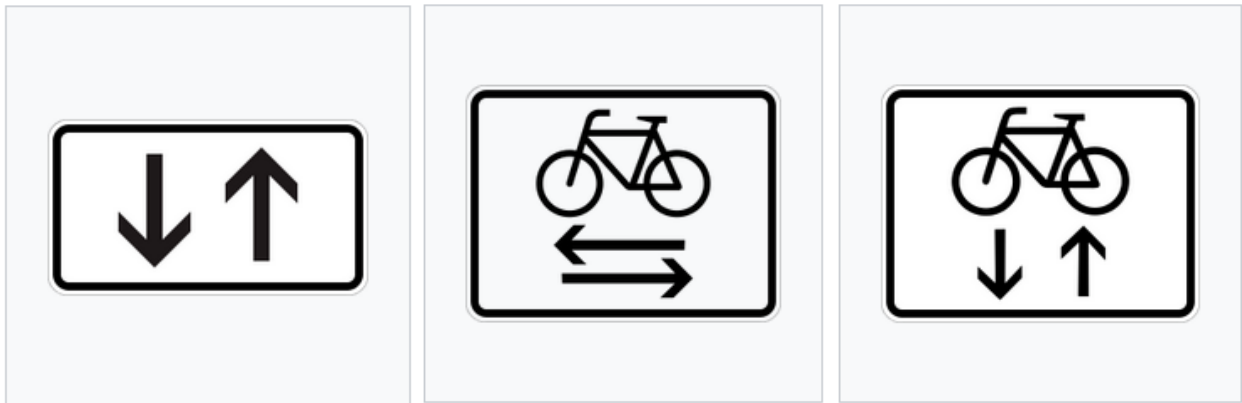
Abbildung 38: Zusatzzeichen zur Kennzeichnung von Zweirichtungsradwegen von links nach rechts: 1000-31 (empfohlen), 1000-32 (empfohlen, an Kreuzungen über vorfahrtsregelnden Zeichen verpflichtend); 1000-33 (nicht mehr gültig)
