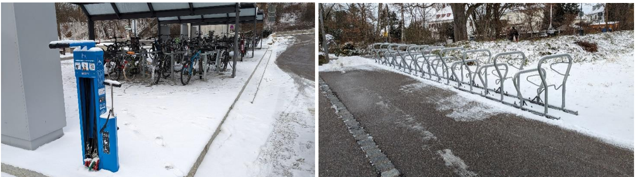
Abbildung 50: Überdachte Abstellanlagen mit Anlehnbügeln und Servicestation am Bahnhof Friedberg (links) oder Abstellanlagen Typ BETA mit hohen Kapazitäten und wenig Flächenverbrauch am Stadtbad Friedberg (rechts)
