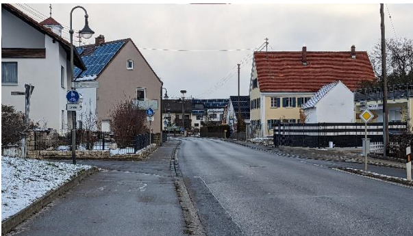
Abbildung 30: Entspricht nicht den Anforderungen an qualitativ hochwertige Radverkehrsanlagen: Die Führung über einen Gehweg innerorts (links), und über einen straßenbegleitenden Gehweg, Rad frei außerorts (rechts)
