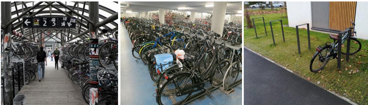
Abbildung 57: links und Mitte: Fahrradabstellanlage mit hoher Kapazität (Typ 3); rechtes Foto: Fahrradabstellanlage mit niedriger Kapazität (Typ 4).
